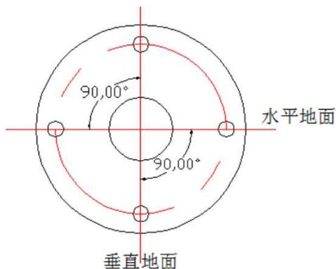
图 6 对装法兰盘焊接示意图
